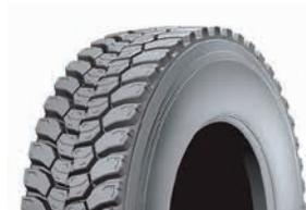
Rechapage spécialement conçu pour les véhicules à usage mixte :
